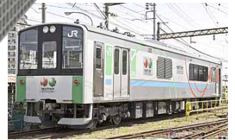
JR東日本が開発中の「蓄電池駆動車システム」の試験車両
